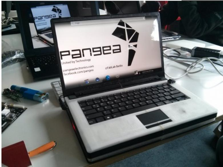
Ein Prototyp des Pangea Sun, das Gehäuse und die Modulfassungen wurden mit einem 3D-Drucker hergestellt. (Foto: Alexander Merz/Golem.de)
